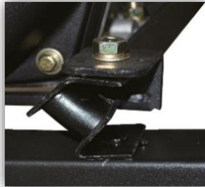
**Качественные вибропоглощающие подушки** в местах крепления узлов генератора к раме значительно снижают уровень вибрации и шума во время его эксплуатации
